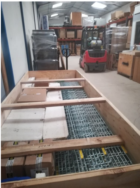
Chemin de câble fil inox pour le Niger
