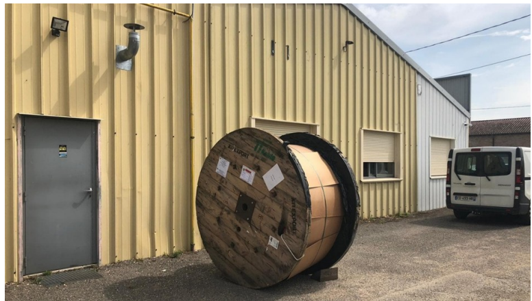
Câble 3x120 XLPE 11Kv pour ENI
